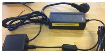
3. Strömadapter (beteckning PS12-20A) till PA2 ansluts till PA2 anslutningsuttag **Power**.
